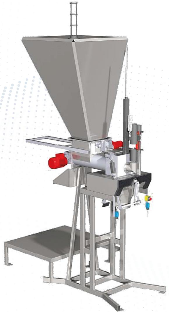
Dans cet appareil, le système de pesée est situé sur l'embout, et le plateau de la balance devient le sac au moment du dosage – c'est ce qu'on appelle la balance brute.
