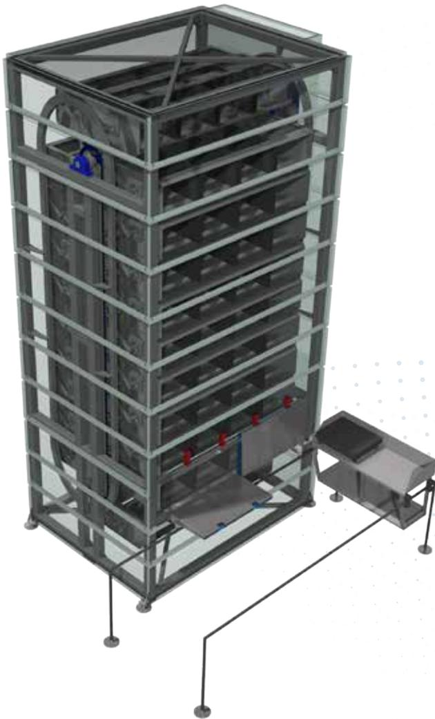
L'étagère automatique, dans sa configuration standard, dispose de 20 étagères de stockage, chacune divisée en quatre compartiments prévus pour y placer des contenants de stockage typiques.
