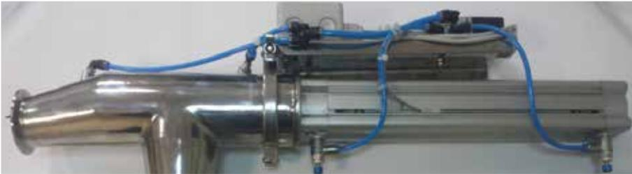
**Prélève-sous-convoyeur PPR-01** – Il est principalement utilisé pour les produits granulés.
