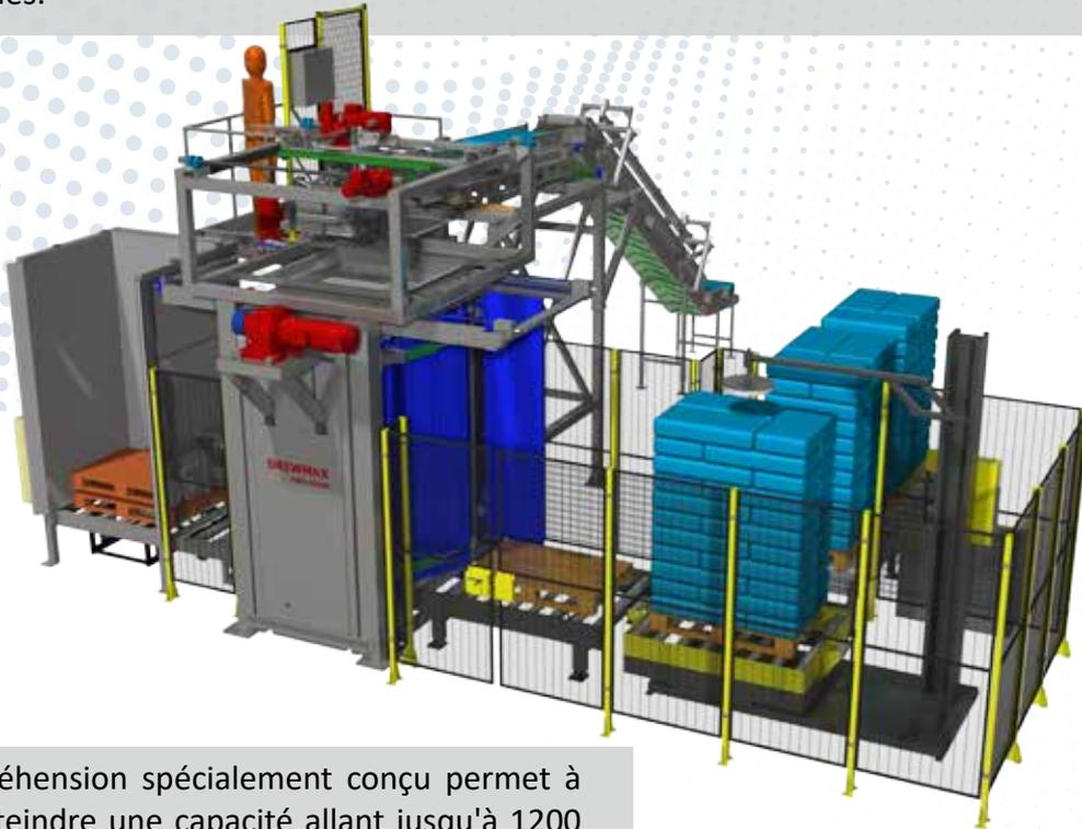
Le bras de préhension spécialement conçu permet à l'appareil d'atteindre une capacité allant jusqu'à 1200 emballages par heure. Le palettiseur peut être équipé en option d'un dispositif d'alimentation en palettes vides ainsi que d'un magasin pour les intercalaires, en fonction des besoins. Notre domaine d'activité comprend le conseil, la conception, la fabrication et le service après-vente chez le client.
