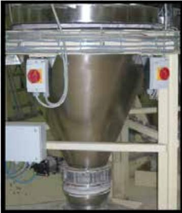
Balança cônica – As balanças cônicas são amplamente reconhecidas, especialmente na indústria alimentícia, devido à sua forma e facilidade de manutenção da limpeza.
