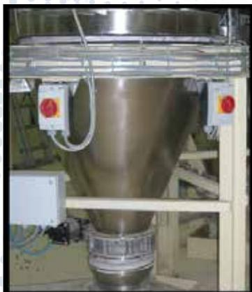
**Báscula cónica** – Las básculas cónicas son especialmente apreciadas en la industria alimentaria debido a su forma y facilidad para mantener la limpieza.
