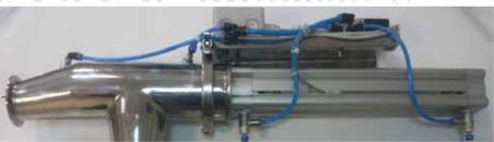
**Redlerprobennehmer PPR-01** – Wird hauptsächlich für granulierte Produkte verwendet.
