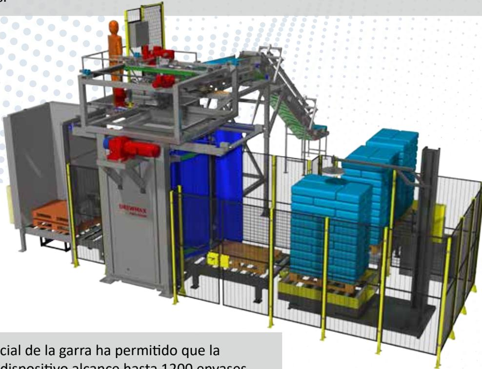
El diseño especial de la garra ha permitido que la capacidad del dispositivo alcance hasta 1200 envases por hora. El paletizador puede ser adicionalmente equipado con un alimentador de palets vacíos, así como con un almacén de separadores según las necesidades. Nuestro ámbito de actividad incluye asesoramiento, diseño, fabricación y servicio en las instalaciones del cliente.
