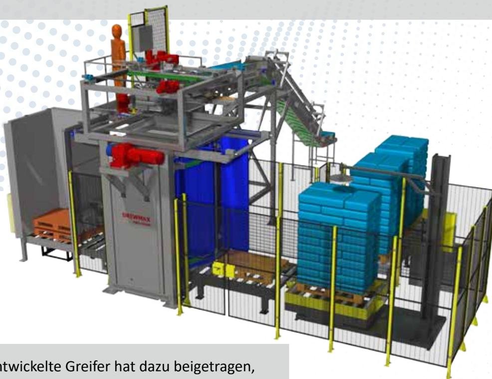
Der speziell entwickelte Greifer hat dazu beigetragen, dass die Leistung des Geräts bis zu 1200 Verpackungen pro Stunde beträgt. Der Palettierer kann zusätzlich mit einem leeren Palettenförderer sowie einem Magazin für Zwischenlagen je nach Bedarf ausgestattet werden. Unser Tätigkeitsbereich umfasst Beratung, Projektierung, Ausführung und Kundendienst.
